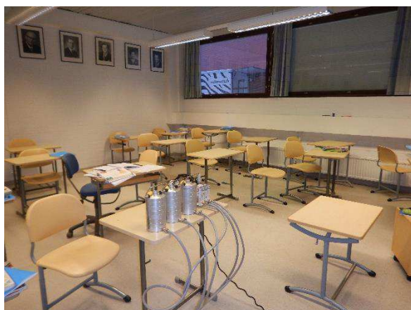
Kuva 1. Mikrobi-ilmanäytteet kerättiin Andersenin keräimellä kasvatusalustoille oleskeluvyöhykkeeltä (kuvassa Luokka 8).
