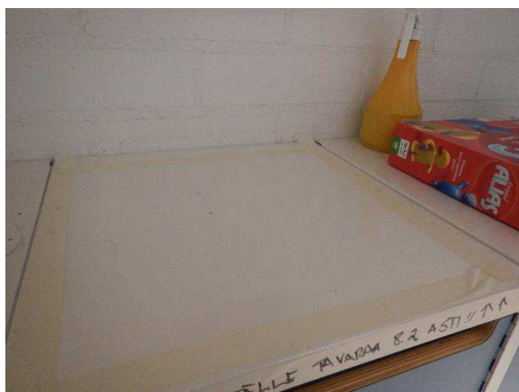
Kuva 7. Kuitunäytteet kerättiin puhdistetulle tasopin- nalle 14 vuorokauden ajan.
