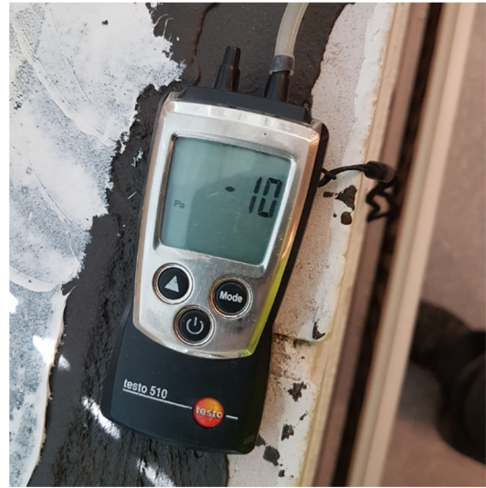
Kuvat 1–2. Luokkatila alipaineistettiin ovipuhaltimella. Kuvan paine-ero (-10 Pa) luokkatilan 219 ja ulkoilman välillä.
