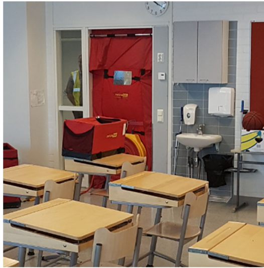
Kuvat 1–2. Luokkatila alipaineistettiin ovipuhaltimella. Kuvan paine-ero (-10 Pa) luokkatilan 219 ja ulkoilman välillä.
